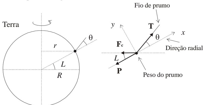
À medida que a Terra gira em torno de seu eixo o peso do prumo descreve uma trajetória circular de raio  $r = R \cos L$  e, portanto, está sujeito a uma força centrípeta ( $F_c$ ) que é a resultante das forças peso do prumo ( $P$ ) e tensão no fio do prumo ( $T$ ) na direção radial. Vamos aplicar a segunda lei de Newton ao prumo. Em  $x$ :
