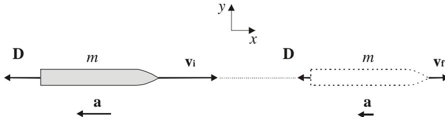
(a) O movimento da barça é retardado por uma aceleração variável, pois a força de arrasto da água depende da velocidade do barco. Aplicando-se a segunda lei de Newton ao barco, na coordenada  $x$ :
